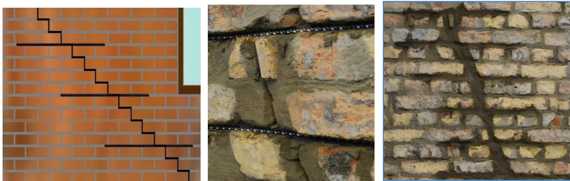
Slika B.3.7. – Popravka pukotina ugradnjom spiralnih šipki
