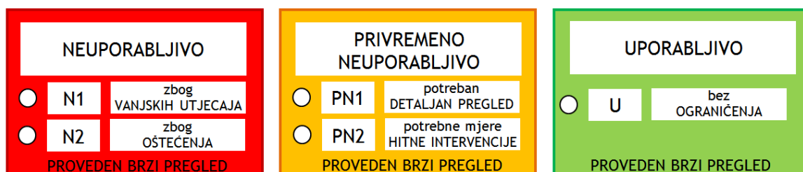
Slika B.2.2. – Razine oštećenja koje su utvrđivane brzim pregledima
